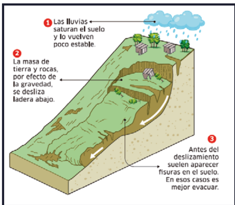
54 Imagen de deslizamiento.
